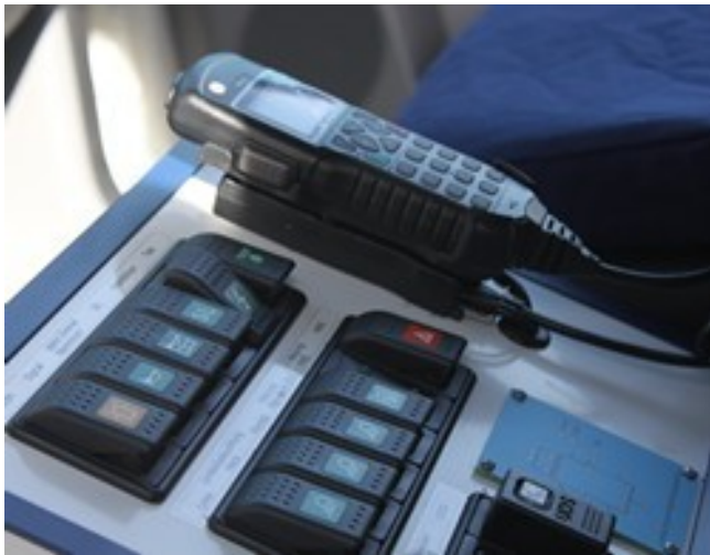
Bild: Einbau einer Handbedienkonsole im RTW. Bildquelle: www.münsterland.de
